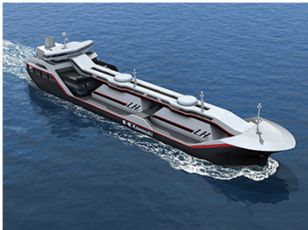
Fig. 34 Vloeibaar waterstof carrier (bron Kawasaki Heavy Industries)
